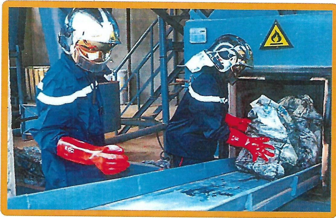
Chargement du four
